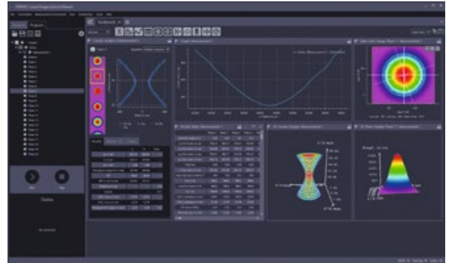
FM+および最新レーザ解析ソフトウェアLDS (LaserDiagnosticsSoftware)の代表的な測定結果
